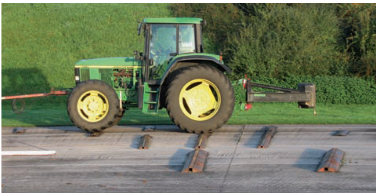
Obrázek 5: Traktorový trojúhelník se zatěžovacím nosníkem a závažím během zkoušky životnosti.
