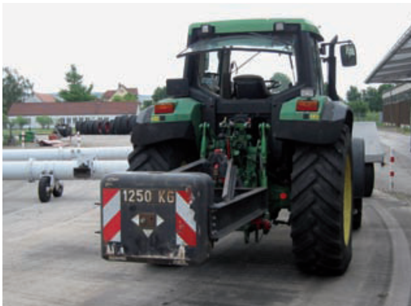
Obrázek 2: Traktorový trojúhelník namontovaný na zkušební traktor se zatěžovacím nosníkem a závažím během zkoušky životnosti.
