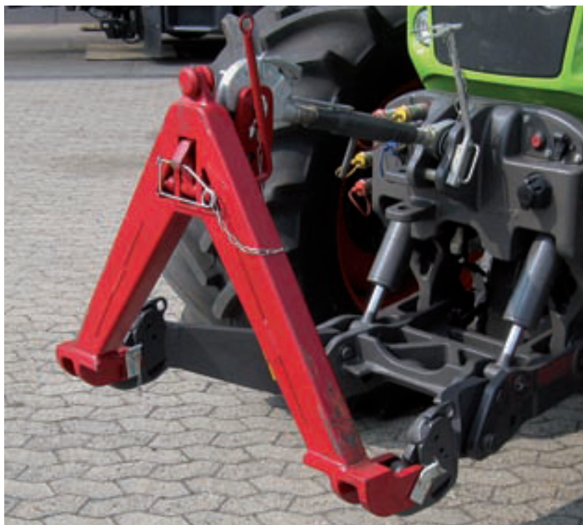
Obrázek 4: Namontování trojúhelníku v předním hydraulickém závěsu
