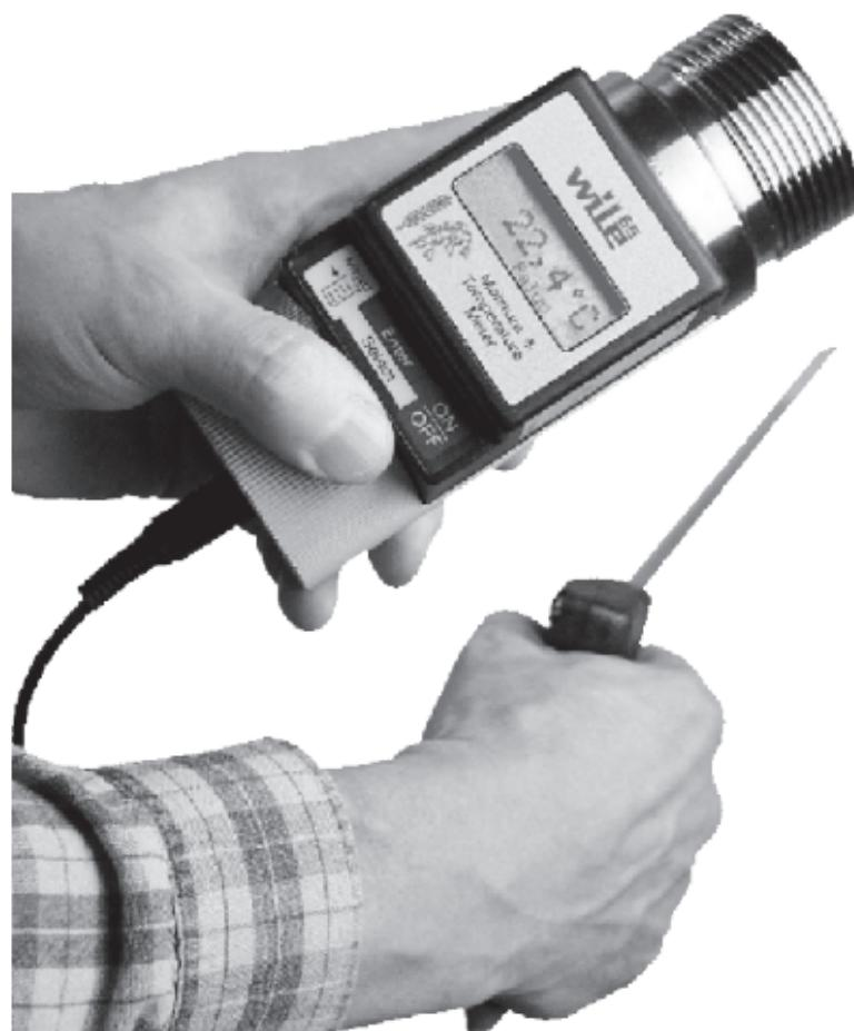
Зонд Wile-651 измеряет температуру (0-60°C) в зерне, сене, торфе, компосте.
