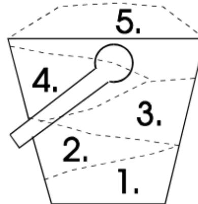
2. Плотно вставьте зонд в фураж, чтобы он имел полный контакт с образцом. Зонд не должен касаться ведра.
