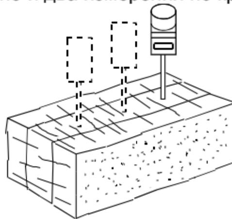
В круглых тюках измерение влажности производится в нескольких точках вокруг тюка.
