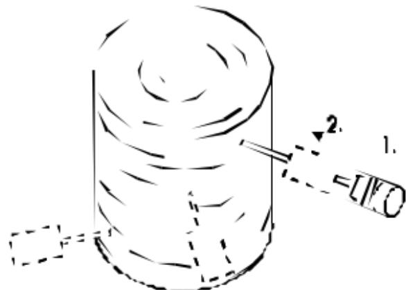
Använd alltid den korta mätsonden W-251 för skala 1 och den långa mätsonden W-252 för skala 2.
