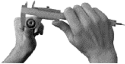
Figura 4, Control de la medida de apriete
