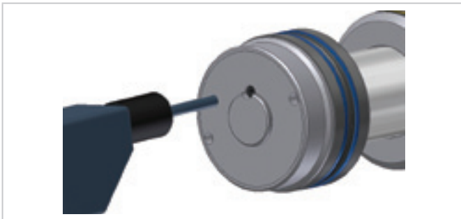
Fig. 6 Percer l'écrou borgne
