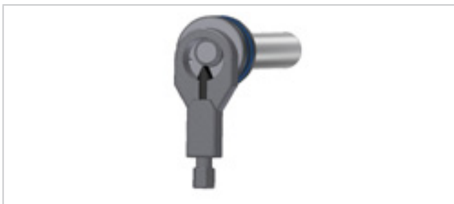
Fig. 4 Fendre la bague de compression
