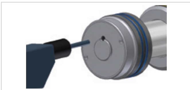
Fig. 6 Percer l'écrou borgne
