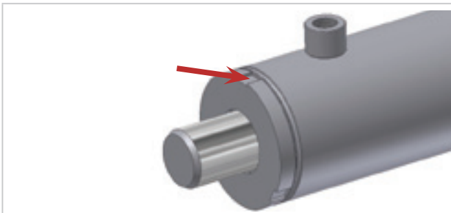
Fig. 2 Repousser la lèvre de sécurité
