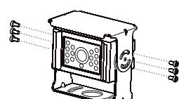
Montare la telecamera con l'aletta parasole sulla staffa di montaggio.
