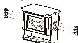
Die Kamera bei der Montage mit der Sonnenblende an der Halterung befestigen.
