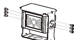
Fixez la caméra et le pare-soleil au support de montage lors de l'installation.
