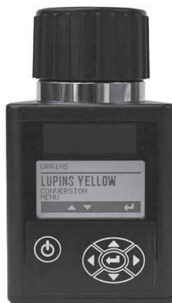
Il tester è specialmente accurato quando sia I grani che l'apparecchio si trovano a temperatura tra 16°C and 32°C. Per il miglior risultato, la temperatura dei grani non dovrebbe trovarsi al di sotto dei 4°C o al di sopra di 43°C. La condensa sulle pareti della cella o sui grani è facilmente evitabile avendo apparecchio e campione alla stessa temperatura.
