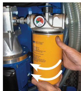
Afb. 6: Losdraaien van filter tegen de klok in.
