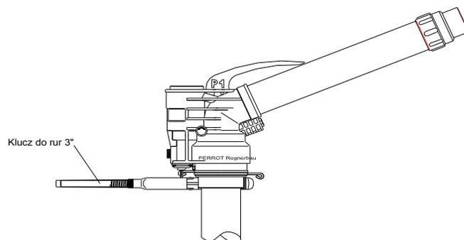
W celu uniknięcia odkręcenia zraszacza w czasie pracy należy nakręcić go na rurę, aż do oporu znajdującego się na końcu gwintu zraszacza.
