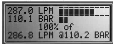
Cet affichage sert à tester le rendement volumétrique de la pompe. L'écran affiche initialement le débit et la pression sur les deux lignes supérieures comme sur l'affichage 2 et la puissance sur les deux lignes inférieures. Une fois le point de référence du rendement capturé, la troisième ligne affichera alors le rendement actuel et la ligne inférieure indiquera le point de référence, les deux lignes supérieures continueront d'indiquer le débit et la pression actuels.
