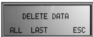
Die Optionen zum Löschen werden durch die "Softmenü"-Kennzeichner in Zeile 4 angegeben und ermöglichen entweder das Löschen des letzten Datenelements oder aller Datenelemente.
