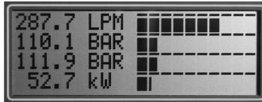
Auf diesem Bildschirm werden die Messwerte in der gleichen Reihenfolge wie in Bildschirm 1 angezeigt, wobei jedoch der Wert, die Maßeinheiten und ein Balkendiagramm in Verbindung mit dem entsprechenden Wert dargestellt werden. Das Balkendiagramm reicht von Null bis zum Höchstwert des Testers (siehe unten). In der unteren Zeile wird je nach Auswahl die Leistung oder die Temperatur angezeigt.
