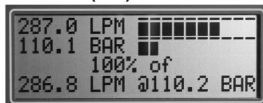
Esta pantalla se usa para comprobar el rendimiento volumétrico de la bomba. Al principio, en las dos primeras líneas de la pantalla se muestran los valores de caudal y presión, igual que en la PANTALLA 2, y en las dos líneas inferiores, la potencia. Una vez capturado el punto de referencia del rendimiento, en la tercera línea se indica el rendimiento actual y en la línea inferior se muestra el punto de referencia. Las dos líneas superiores seguirán mostrando el caudal y la presión actuales.
