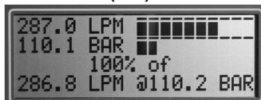
Dieser Bildschirm dient zum Testen des Liefergrads einer Pumpe. Auf dem Bildschirm werden anfangs wie in Bildschirm 2 der Durchfluss und der Druck in den oberen zwei Zeilen und die Leistung in den unteren zwei Zeilen angezeigt. Ist der Effizienz-Referenzpunkt erfasst, wird in der dritten Zeile die Ist-Effizienz und in der unteren Zeile der Referenzpunkt angezeigt. In den oberen zwei Zeilen werden nach wie vor die Ist-Durchflussmenge und der Druck angezeigt.
