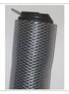
Auf dem Verteilerröhrchen des Verteilers, an dem die Schlauchabschaltung montiert werden soll, einen Abstand von 40 mm markieren.
