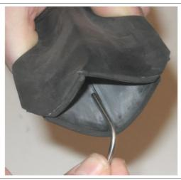
Schlauchabschaltung in den Schlauch (TSC.004) schieben, bis der untere Haltewulst am Schlauch anliegt.
