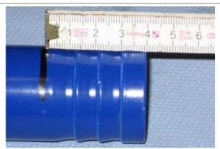
Den markierten Abschnitt des Verteilerröhrchens großzügig mit Fett benetzen.
