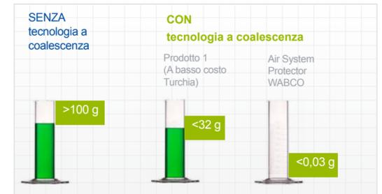
Condizioni di prova: Compressore a due cilindri 704 cm<sup>3</sup> con regolazione alta temperatura, 12,5 bar e ciclo di funzionamento 50%; calcolo basato sulla misurazione degli aerosol a valle dell'essiccatore d'aria
