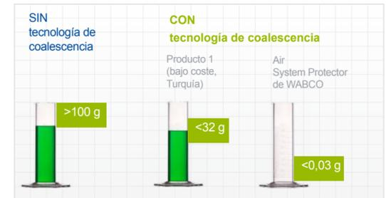
Condiciones de la prueba: compresor de dos cilindros de 704 cm³ con configuración de temperatura alta, 12,5 bar y 50 % del ciclo de funcionamiento; cálculo basado en la medición del aerosol que desciende por el secador de aire
