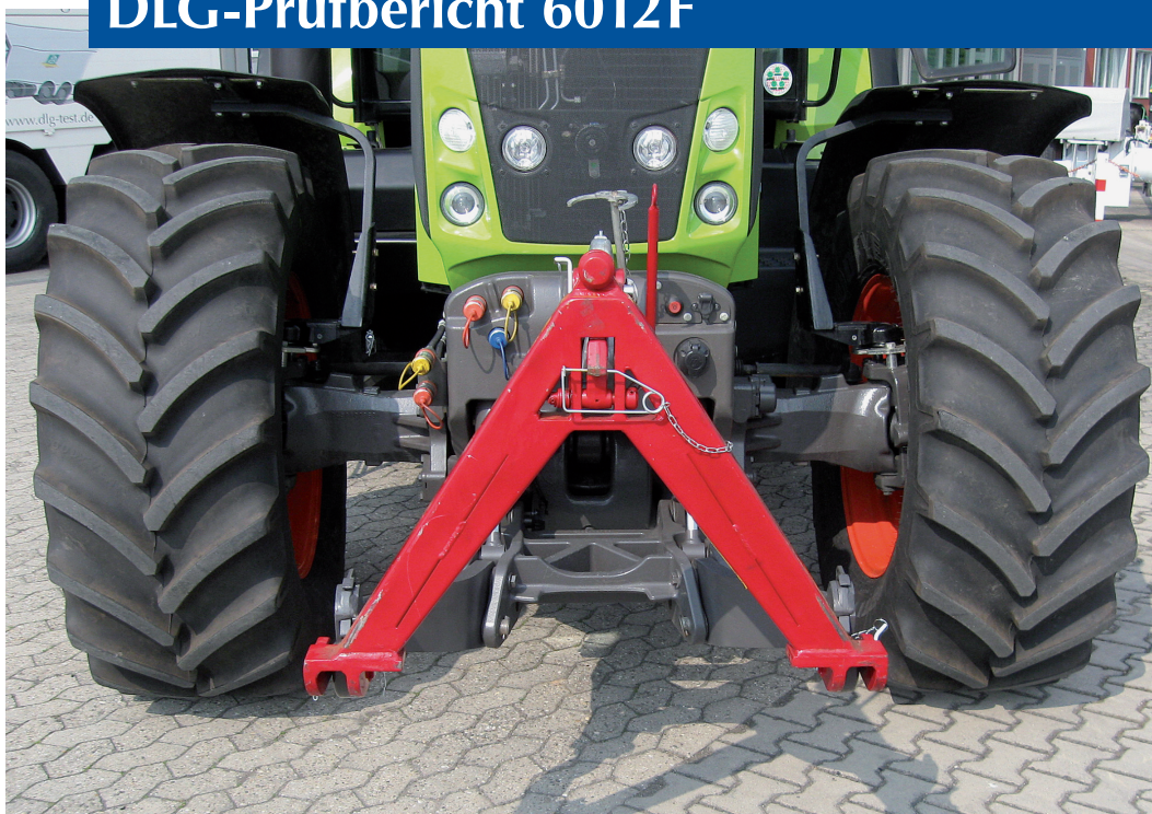
Bild 1: Schlepperdreieck Kategorie 2S im Frontkraftheber
