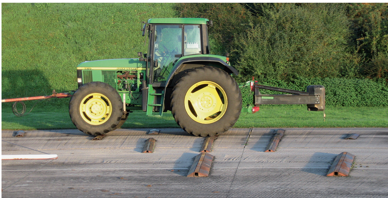
Bild 5: Das Schlepperdreieck mit Ballasträger und Ballast während der Dauerprüfung
