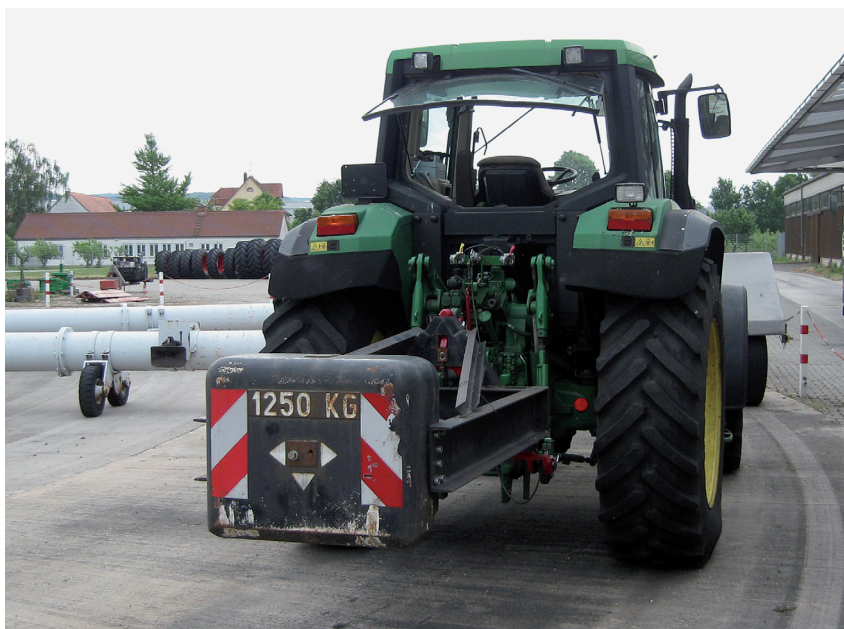
Bild 2: Das an den Testschlepper angebaute Schlepperdreieck mit Ballasträger und Ballast während der Dauerprüfung.
