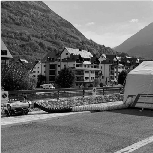
Master BV 77 opvarmning af brandtelt til brandvæsen
