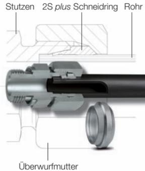
Für die Funktionserfüllung der 2S plus Schneidringverschraubungen ist die Einhaltung der Montageanleitung von größter Bedeutung. Eine fehlerhafte Handhabung führt zu Risiken in Bezug auf die Sicherheit und Dichtheit, die unter Umständen auch den kompletten Ausfall der Verbindung zur Folge haben kann.
