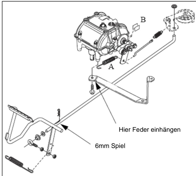
Die Feder wird in der Bohrung des Bremshebels und in der Nut des Umlenkrollen- Halters eingehangen. Art. Nr.: 1131-1497-01
