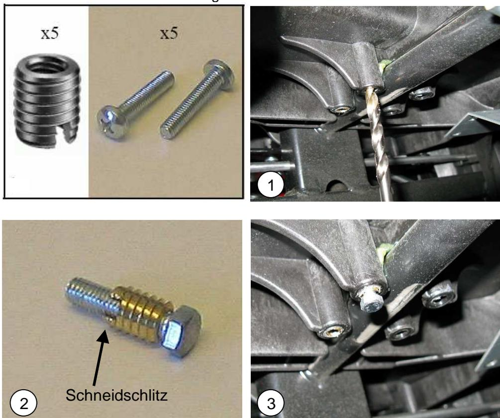
1. Bohren Sie das Schraubenloch auf  $\text{\O}6,8\text{mm}$  auf. (Auf Bohrtiefe achten)
