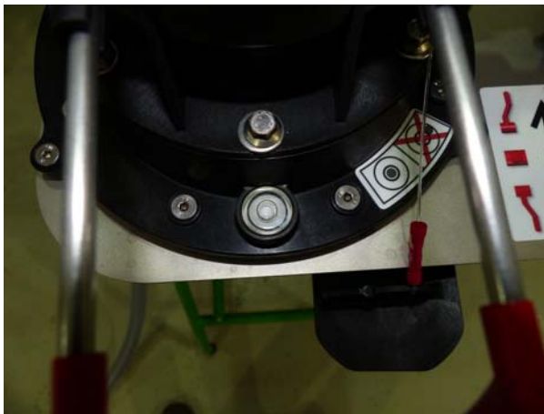
Abb. 3: Für das genaue Abmessen von Teilmengen muss das Füllsystem möglichst waagrecht aufgestellt werden. Eine Libelle erleichtert die Ausrichtung.
