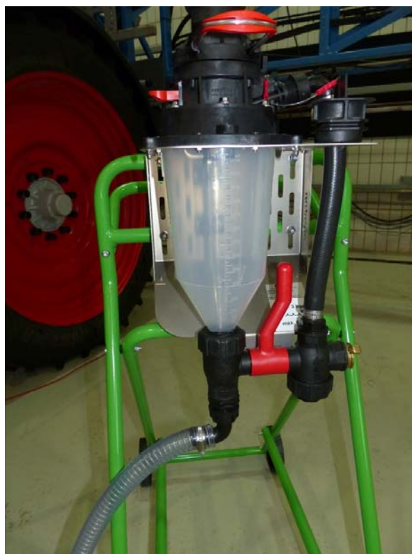
Füllsystem mit Messeinrichtung für Pflanzenschutzmittel Agrotop „easyFlow M“
