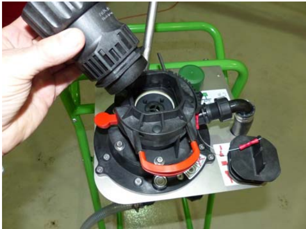
Abb. 2: Die Gebindeadapter passen für 63 mm Schraubverschlüsse.
