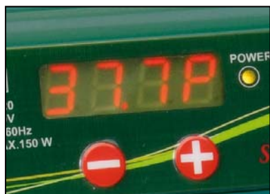
Affichage avec température en phase de programmation (température suivie par « P »)
