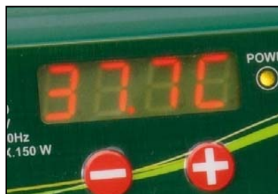
Affichage avec température intérieure actuelle (température suivie par « C »)
