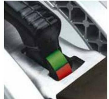
Verschleißanzeige für Reibbeläge vorne/hinten und Kupplungsmechanismus.
