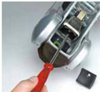
Reibbelag hinten: Torxschraube entfernen. Reibbelag austauschen und Torxschraube wieder einschrauben.
