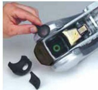
Reibbeläge seitlich: außen rote Abdeckkappen entfernen. Reibbeläge von außen nach innen herausschlagen. Neue Reibbeläge von innen hineindrücken.
