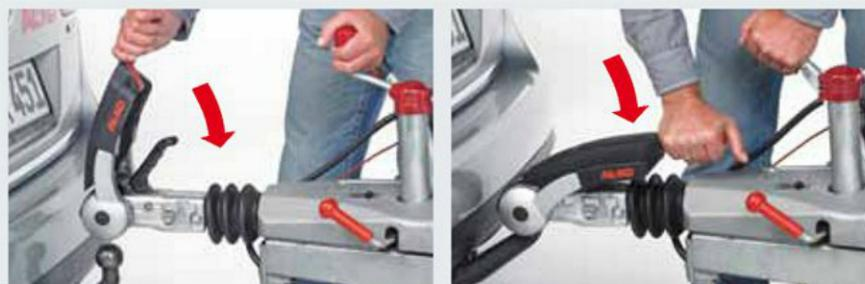
AKS™ mittels Kupplungsgriff auf die Kugel setzen (Kugel muss fettfrei und blank sein).
