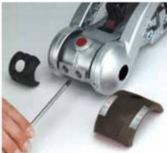
Reibbelag vorne: Soft-Dock abnehmen. Die beiden Torxschrauben entfernen. Reibbelag austauschen. Torxschrauben anbringen. Soft-Dock aufsetzen.
